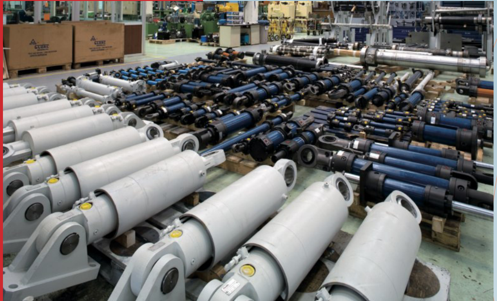
Cilindros de doble efecto sumergidos en agua para accionamiento de clapeta / azud. Double acting cylinders submerged in water to drive a weir valve. Vérins double effet immergés dans l'eau pour actionnement clapet/seuil. Doppeltwirkende Tauchzylinder in Wasser zur Ansteuerung der Klappe/Sperre.
